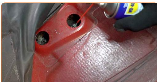
**4** Afloje la sujecion superior del amortiguador. Use un vaso de impacto del n.º 13. Utilice una llave de trinquete.
