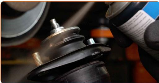
**25** Coloque el amortiguador en el arco de la rueda y fíjelo.
