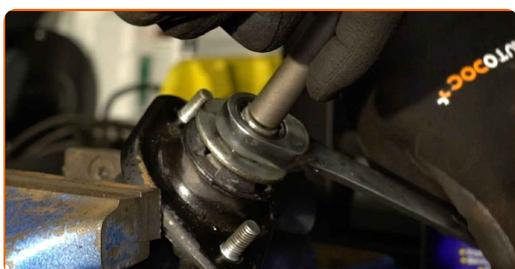
**20** Retire el soporte superior del amortiguador.
