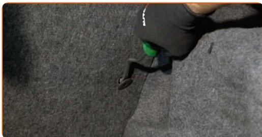
**3** Separe el revestimiento de la parte lateral del maletero.
