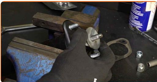
**22** Apriete la tuerca de la varilla del amortiguador. Use un vaso de impacto del n.º 16. Utilice un vaso para amortiguador DDNº6 Utilice una llave dinamométrica. Apriételo a un par de 37 Nm.
