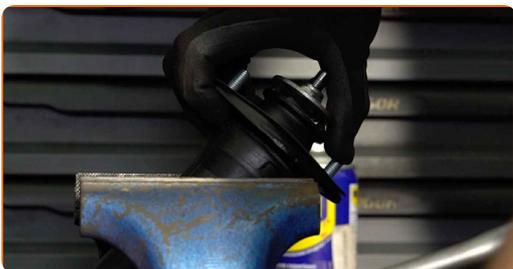
**24** Trate la sujeción de la varilla del amortiguador. Use grasa de cobre.
