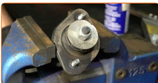
**18** Limpie la sujeción del vástago del amortiguador. Use un cepillo de alambre. Use el aerosol WD-40.
