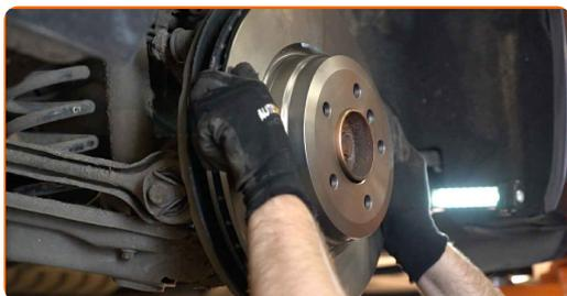
**25** Apriete la fijación del disco de freno. Use Vaso HEX No. H5. Utilice una llave dinamométrica. Apriételo a un par de 16 Nm.
