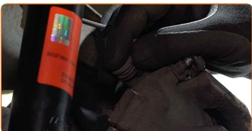
**23** Instale el sensor de desgaste de las pastillas de freno. Use alicates de punta redondeada.
