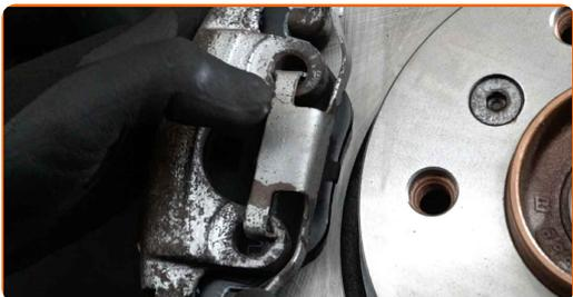
**21** Apriete las sujeciones de la pinza del freno. Use Vaso HEX No. H7. Utilice una llave dinamométrica. Apriételo a un par de 30 Nm.
