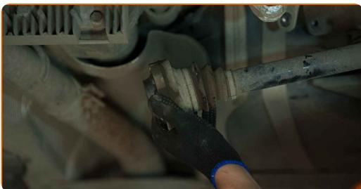
**31** Destornille los bulones de fijación del cojinete del cubo de la rueda trasera. Use un vaso de impacto del n.º E14. Utilice una llave de trinquete.
