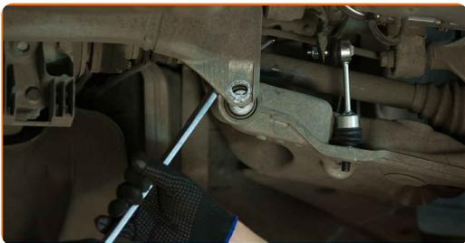
**29** Destornille los bulones de fijación del árbol de impulsión del reductor. Use un vaso de impacto del n.º E12. Utilice una llave de trinquete.
