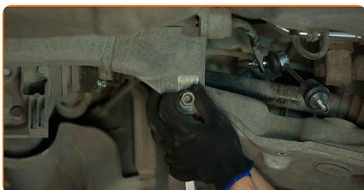
**45** Atornille la fijación trasera de la palanca. Usa una llave mixta del n.º 18. Use un vaso de impacto del n.º 18. Utilice una llave de trinquete.
