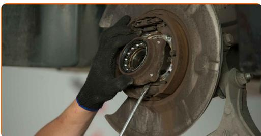
**34** Presione el cubo de la rueda en el cargador interior del cojinete. Utilice un juego de cubos y rodamientos. Utilice un martillo.
