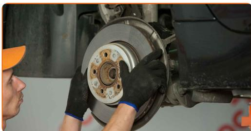
**56** Apriete la fijación del disco de freno. Use Vaso HEX No. H6. Utilice una llave dinamométrica. Apriételo a un par de 16 Nm.
