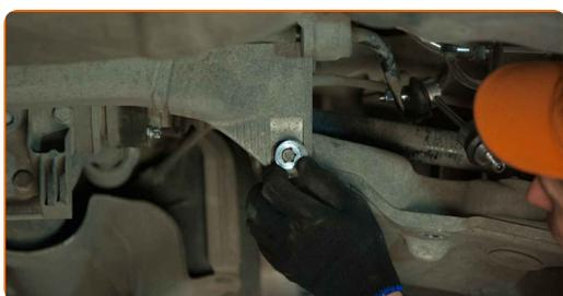
**43** Atornille la fijación trasera de la palanca. Usa una llave mixta del n.º 18.
