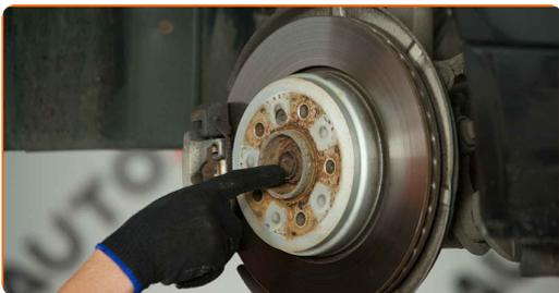
**7** Destornille la fijación del cubo de la rueda. Use un vaso de impacto del n.º 36. Utilice una llave de trinquete.
