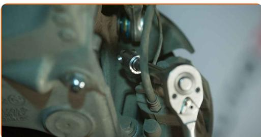
**11** Retire la pinza del freno junto con su soporte. Utilice un destornillador plano.
