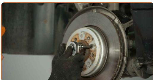
**57** Limpie los asientos de montaje de la pinza de freno y su soporte. Use un cepillo de alambre. Use el aerosol WD-40.
