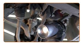
Retire la cubierta del brazo de control.
