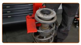
Destornille la tuerca de la varilla de la pata amortiguadora. Use un vaso de impacto del n.º 22. Use Vaso HEX No. H7. Utilice una llave de trinquete.
