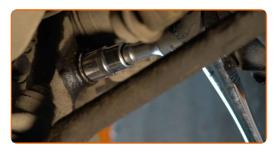
Retire la pinza del freno junto con su soporte. Use una palanca.
