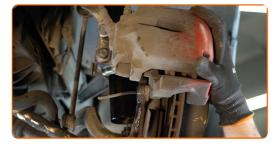
Apriete la fijación de la pinza del cáliper de freno. Use un vaso de impacto del n.º 18. Utilice una llave dinamométrica. Apriételo a un par de 110 Nm.
