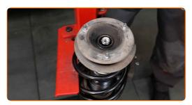
Apriete la tuerca de la varilla de la pata amortiguadora. Use un vaso de impacto del n.º 22. Use Vaso HEX No. H6. Utilice una llave dinamométrica. Apriételo a un par de 64 Nm.
