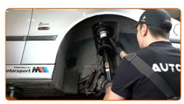
Atornillen la fijación superior de la cazoleta de la pata amortiguadora. No lo apriete.
