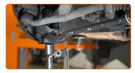
Atornille la sujeción trasera que conecta el brazo de control al subchasis. Usa una llave mixta del n.º 16. Use un vaso de impacto del n.º 18. Utilice una llave de trinquete.
