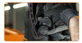
Instale el soporte de montaje del amortiguador usando el orificio central como guía.
