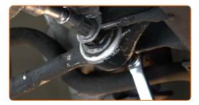
Atornille la fijación delantera de la palanca. Usa una llave mixta del n.º 18. Use un vaso de impacto del n.º 18. Utilice una llave de trinquete.
