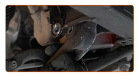
Limpie las sujeciones que conectan el puntal amortiguador a la mangueta de dirección. Use un cepillo de alambre. Use el aerosol WD-40.
