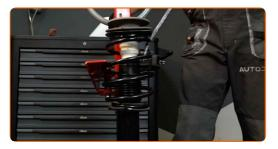
Retire el puntal amortiguador que está montado.
