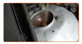
97 Instale la tapa del soporte del amortiguador.
