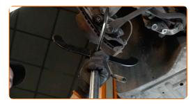
Desatornille la sujeción trasera que conecta el brazo de control al subchasis. Usa una llave mixta del n.º 16. Use un vaso de impacto del n.º 18. Utilice una llave de trinquete.
