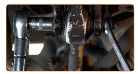
Apriete las sujeciones inferiores que conectan el amortiguador con la mangueta de dirección. Usa una llave mixta del n.º 18. Use un vaso de impacto del n.º 16. Utilice una llave dinamométrica. Apriételo a un par de 81 Nm.
