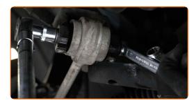
Apriete el tornillo de sujeción trasero que conecta el brazo al subchasis del automóvil. Usa una llave mixta del n.º 16. Use un vaso de impacto del n.º 18. Utilice una llave dinamométrica. Apriételo a un par de 110 Nm.
