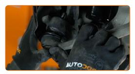
Atornille la tuerca de sujeción que conecta el extremo de la barra de acoplamiento a la mangueta de dirección. Usa una llave mixta del n.º 18.
