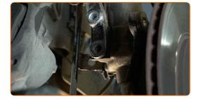
Limpie las sujeciones que conectan el extremo de la barra de acoplamiento con la mangueta de dirección. Use un cepillo de alambre. Use el aerosol WD-40.
