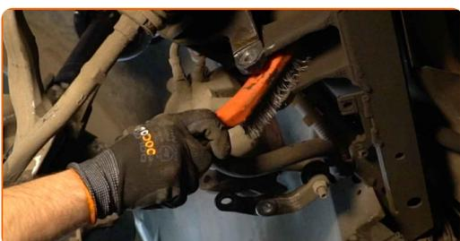
**62** Instale la sujeción trasera del brazo de control.
