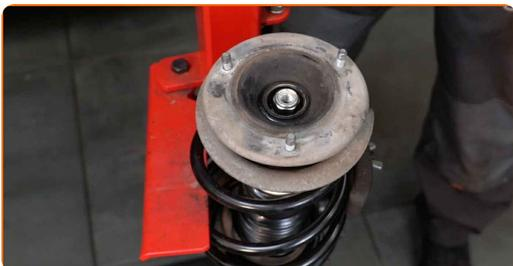
**51** Apriete la tuerca de la varilla de la pata amortiguadora. Use un vaso de impacto del n.º 22. Use Vaso HEX No. H6. Utilice una llave dinamométrica. Apriételo a un par de 64 Nm.
