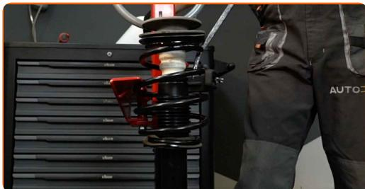
**53** Retire el puntal amortiguador que está montado.
