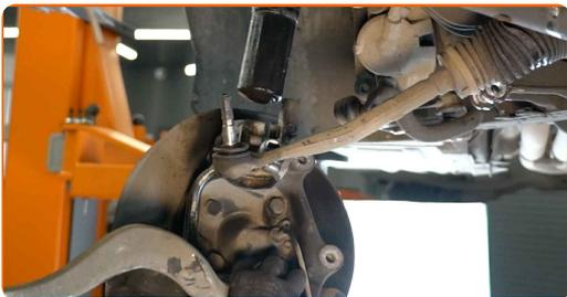
**38** Destornille la fijación superior de la cazoleta de la pata amortiguadora.
