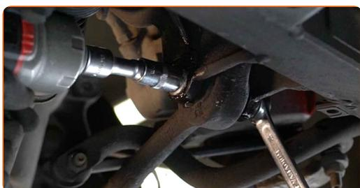
**33** Retire la sujeción trasera del brazo de control.
