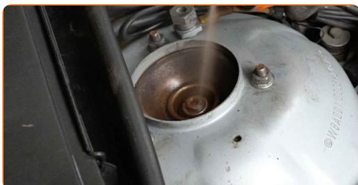
95 Instale la tapa del soporte del amortiguador.
