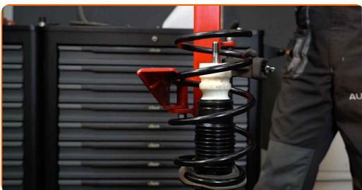
**50** Instale el soporte de montaje superior del puntal y el cojinete del soporte de montaje del puntal.
