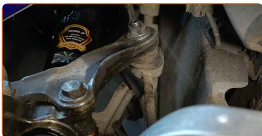
**7** Desatornille la sujeción que conecta la bieleta a la barra estabilizadora. Use un vaso de impacto del n.º 16. Utilice una llave de trinquete.
