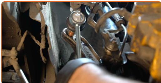
**12** Apriete las fijaciones de la bieleta de la barra estabilizadora. Use un vaso de impacto del n.º 16. Utilice una llave de trinquete.
