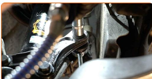
**13** Apriete la sujeción que conecta la bieleta de barra estabilizadora al amortiguador. Use un vaso de impacto del n.º 16. Utilice una llave dinamométrica. Apriételo a un par de 65 Nm.
