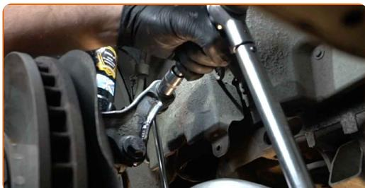
**14** Apriete la sujeción que conecta la bieleta a la barra estabilizadora. Use un vaso de impacto del n.º 16. Utilice una llave dinamométrica. Apriételo a un par de 65 Nm.
