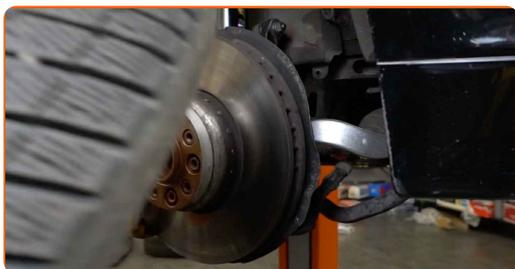
**6** Separe las pastillas de freno. Use una palanca.
