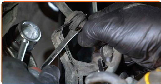
**9** Retire la pinza del freno junto con su soporte.
