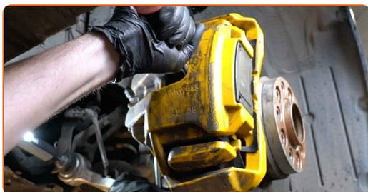
**7** Destornille la fijación de la pinza del cáliper de freno. Use un vaso de impacto del n.º 18. Utilice una llave giramachos.
