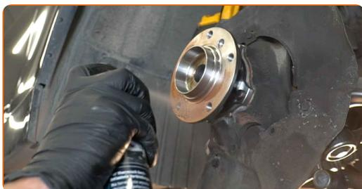
**48** Instale la pinza del cáliper de freno.
