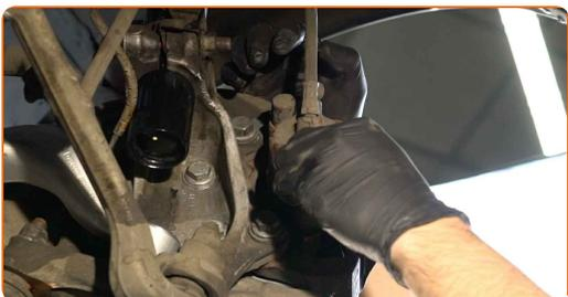
**23** Instale el resorte de fijación del cáliper de freno.
