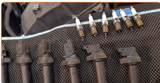
**19** Instale las nuevas bujías en sus asientos de montaje.
