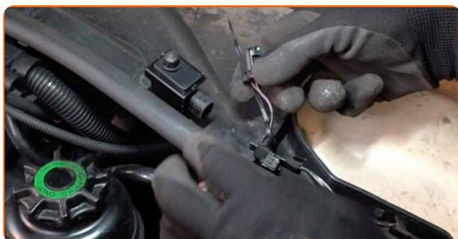
**7** Retire los sensores del climatizador.
