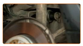
Atornille la fijación delantera de la palanca. Usa una llave mixta del n.º 18 (2 piezas).
