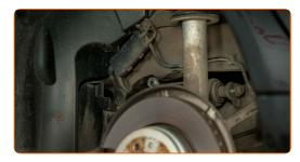
Desatornille la sujeción que conecta el brazo de control a la mangueta trasera. Usa una llave mixta del n.º 21. Use un vaso de impacto del n.º 10. Utilice una llave de trinquete.
