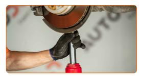
Apriete la sujeción delantera que conecta el brazo de control al subchasis. Usa una llave mixta del n.º 18 (2 piezas). Utilice una llave dinamométrica. Apriételo a un par de 100 Nm.
