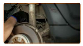
Retire la sujeción delantera del brazo de control. Use una palanca. Utilice un destornillador plano.
