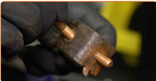
**20** Atornille la sujeción del soporte de la bieleta de suspensión. Use un vaso de impacto del n.º 13. Utilice una llave de trinquete.
