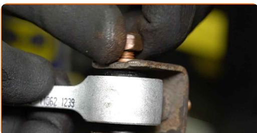
**21** Limpie los asientos de montaje de la bieleta de barra estabilizadora. Use un cepillo de alambre. Use el aerosol WD-40.
