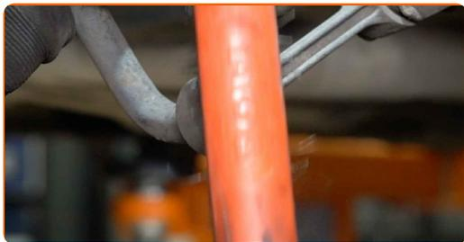
**10** Retire el enlace estabilizador de estabilidad transversal.
