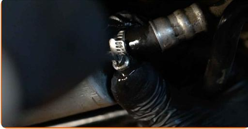
17 Limpie el soporte de montaje del filtro de combustible. Utilice un spray de limpieza multiuso.
