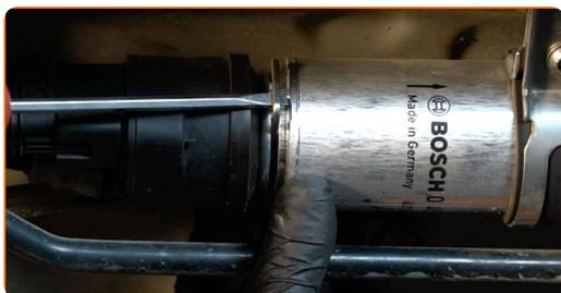
**4** Afloje la abrazadera de sujeción del tubo del filtro de combustible. Utilice un destornillador plano.
