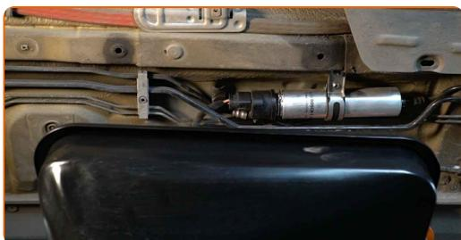
**3** Retire el anillo elástico del clip de retención del regulador de presión de combustible. Utilice un destornillador plano.
