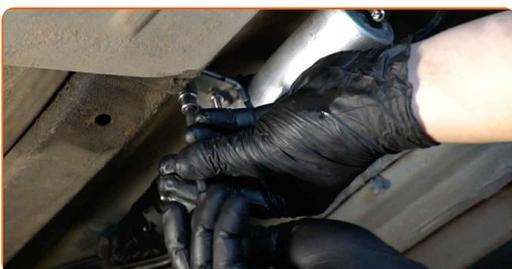
16 Apriete la abrazadera de sujeción del tubo del filtro de combustible. Utilice un destornillador plano.
