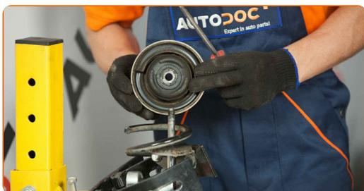
**33** Apriete la tuerca de la varilla de la pata amortiguadora. Usa una llave mixta del n.º 18. Use Vaso HEX No. H7. Utilice una llave dinamométrica. Apriételo a un par de 27 Nm.
