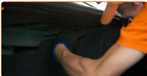
**21** Separe el revestimiento de la parte lateral del maletero.
