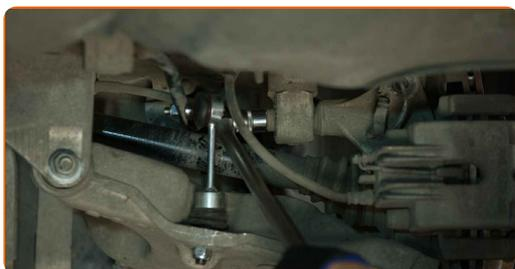
**16** Retire el perno de sujeción. Use una llave mixta del n.º 18. Utilice un destornillador plano.
