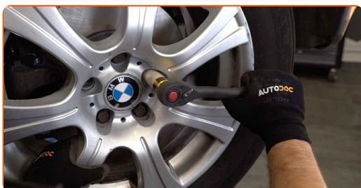
**27** Baje el automóvil y, manteniendo el orden cruzado, apriete los pernos de fijación de las ruedas. Utilice una llave dinamométrica. Apriételo a un par de 140 Nm.
