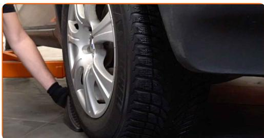
**6** Afloje los pernos de fijación de la rueda. Utilice una llave de impacto para llanta # 19.
