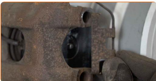
**25** Trate la superficie donde el disco del freno entra en contacto con la llanta de la rueda. Use grasa de cobre.
