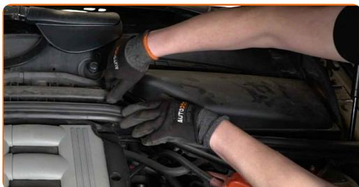
**10** Desatornille las sujeciones de la cubierta de la carcasa del filtro de habitáculo. Use un vaso de impacto del n.º 13. Utilice una llave de trinquete.
