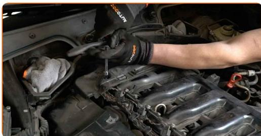
**25** Retire la sección trasera de la cubierta del motor.
