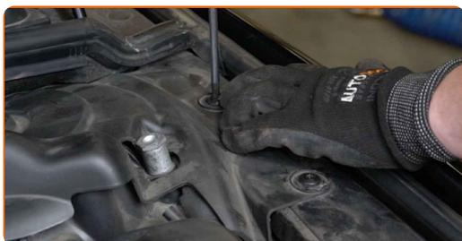
**4** Retire los casquillos protectores de atadura del soporte del strut.
