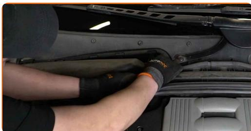
**6** Desatornille las sujeciones de la cubierta de la carcasa del filtro de habitáculo. Use un vaso de impacto del n.º 13. Utilice una llave de trinquete.
