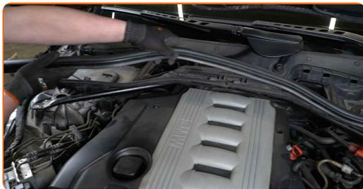
**14** Desenrosque las sujeciones de la parte inferior de la carcasa del filtro de habitáculo. Use un vaso de impacto del n.º 13. Utilice una llave de trinquete.
