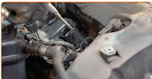
**17** Desenrosque las bujías. Use el vaso de bujía # 16. Utilice una llave de trinquete.
