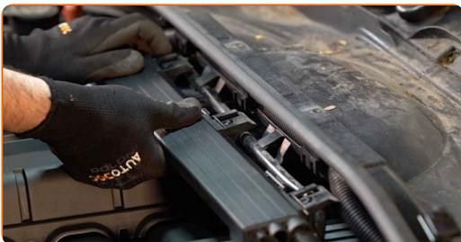
**9** Separe los soportes de la parte superior de la carcasa del microfiltro.
