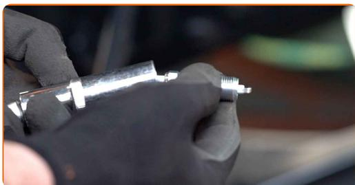
**20** Atornille las bujías nuevas y apriételas. Use el vaso de bujía # 16. Utilice una llave dinamométrica. Apriételo a un par de 27 Nm.
