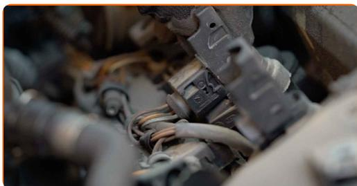
**15** Extraiga las bobinas del encendido de los pozos de la bujía.
