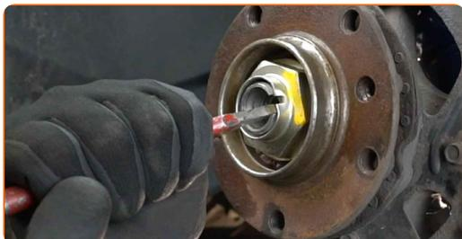
**15** Desenrosque la tuerca del cubo. Use un vaso de impacto del n.º 46. Utilice una llave giramachos.
