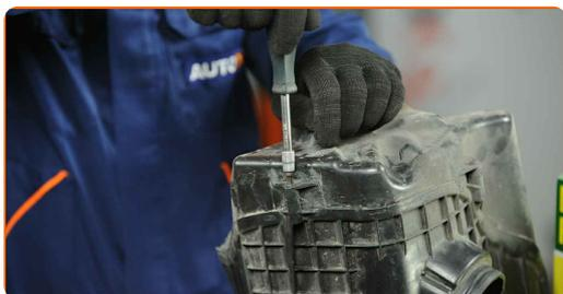
11 Retire la tapa del filtro de aire. Utilice un destornillador plano.
