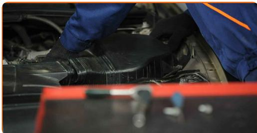
10 Afloje los tornillos de sujeción de la cubierta del filtro de aire. Utilice Torx T25. Utilice una llave de trinquete.
