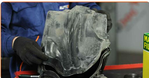
**16** Atornille los tornillos de sujeción de la cubierta del filtro de aire. Utilice Torx T25. Utilice una llave de trinquete.
