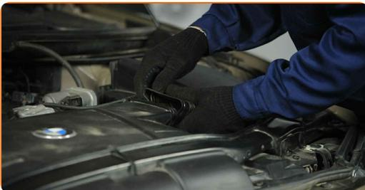
**4** Desenchufe el conector del sensor de flujo de aire. Utilice un destornillador plano.
