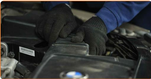
**20** Atornille la abrazadera que conecta la manguera del filtro de aire al cuerpo del acelerador. Utilice un destornillador plano.
