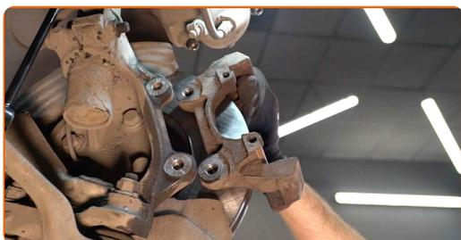
**27** Apriete la fijación de la pinza del cáliper de freno. Use un vaso de impacto del n.º 17. Utilice una llave dinamométrica. Apriételo a un par de 110 Nm.
