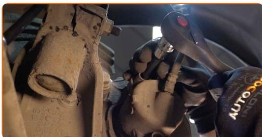
**12** Separe las pastillas de freno. Use una palanca.
