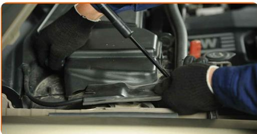
**4** Retire la rejilla de la capucha del limpiaparabrisas situada en el lado izquierdo. Utilice un destornillador plano.
