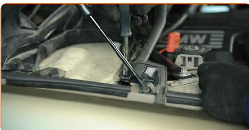
**47** Fije el cableado eléctrico a la parte superior de la carcasa del microfiltro.
