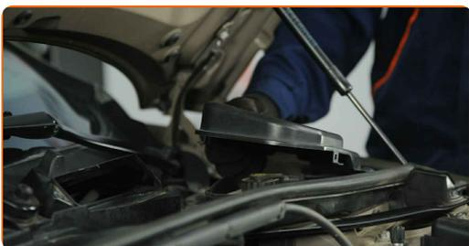
**51** Instale las sujeciones de la rejilla de plástico del capó del limpiaparabrisas.
