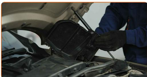
**8** Desenrosque las sujeciones de la rejilla del limpiaparabrisas. Use un vaso de impacto del n.º 8. Utilice una llave de trinquete.
