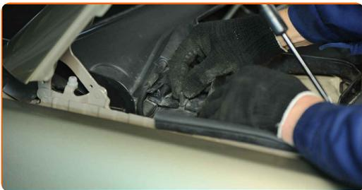
**46** Apriete las sujeciones de la rejilla del limpiaparabrisas. Use un vaso de impacto del n.º 8. Utilice una llave dinamométrica. Apriételo a un par de 11 Nm.
