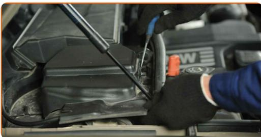
**5** Separe el cableado eléctrico de la parte superior de la carcasa del microfiltro.
