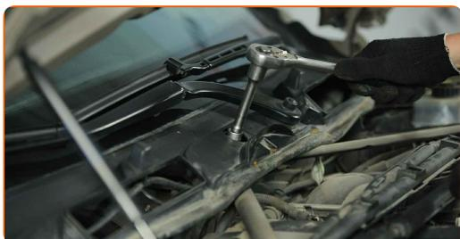
**40** Instale el perno de sujeción.
