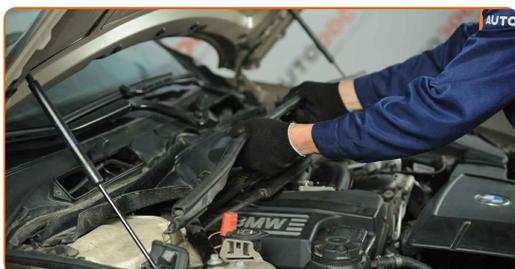
**45** Instale las sujeciones de la rejilla de plástico del capó del limpiaparabrisas.
