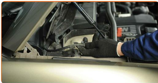
**6** Retire los clips de la rejilla de ventilación plástico del capó. Utilice un destornillador plano.
