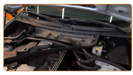
Destornille los bulones de fijación del cuerpo del filtro. Utilice Torx T20. Utilice una llave de trinquete.
