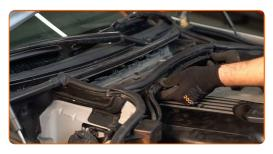
Inserte en la carcasa del filtro el nuevo elemento filtrante. Asegúrese de que el borde del filtro encaje firmemente en la carcasa.
