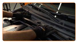
Conecte el arnés del cableado a la carcasa del filtro del habitáculo.
