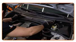
Atornille las sujeciones de la cubierta de la carcasa del filtro de habitáculo.
