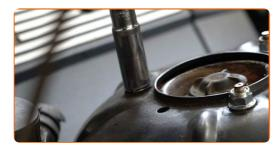
Trate las sujeciones del amortiguador. Use grasa de cobre.
