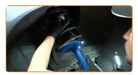
Fije las sujeciones superiores del puntal amortiguador. No lo apriete.
