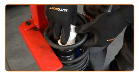
Instale el soporte superior nuevo de la pata amortiguadora.
