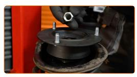
Apriete la tuerca de la varilla de la pata amortiguadora. Use un vaso de impacto del n.º 19. Use un vaso de impacto del n.º 9. Utilice una llave dinamométrica. Apriételo a un par de 52 Nm.
