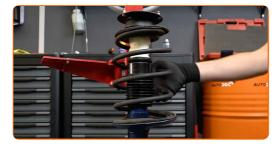
Trate el asiento de montaje del puntal amortiguador en la mangueta de dirección. Use un cepillo de alambre. Use el aerosol WD-40.
