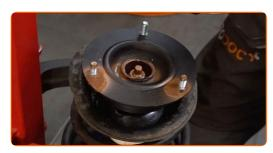
Instale la tapa del soporte del amortiguador.
