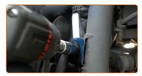
Separe el latiguillo de freno del puntal amortiguador.
