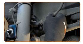
Desconecte el cableado del captador ABS.
