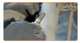
Desconecte el muñón de dirección de la pata amortiguadora.
