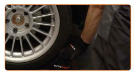
Apriete las sujeciones superiores del amortiguador. Use un vaso de impacto del n.º 13. Utilice una llave dinamométrica. Apriételo a un par de 32 Nm.
