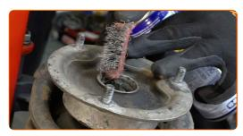
Destornille la tuerca de la varilla de la pata amortiguadora. Use un vaso de impacto del n.º 9. Use un vaso de impacto del n.º 22. Utilice una llave de trinquete.
