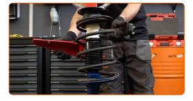
Retire el puntal amortiguador que está montado.
