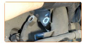
Desatornille las sujeciones superiores del amortiguador.
