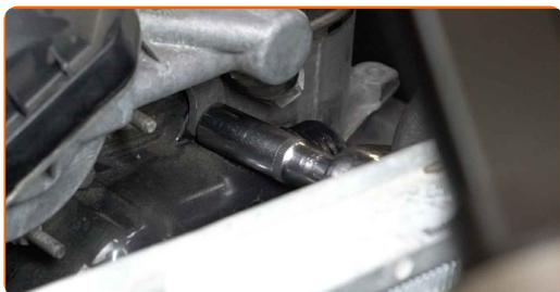
**15** Desenrosque las sujeciones de la carcasa del termostato. Use un vaso de impacto del n.º 10. Utilice una llave de trinquete.
