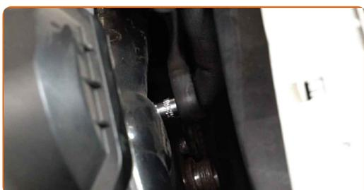
**16** Limpie las sujeciones de la carcasa del termostato. Utilice un spray de limpieza multiuso.
