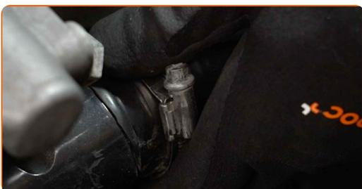
**12** Afloje la abrazadera de la manguera de refrigerante. Use un vaso de impacto del n.º 7. Utilice una llave de trinquete.
