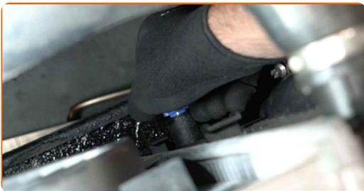
**10** Afloje las abrazaderas de las mangueras de refrigerante. Use un vaso de impacto del n.º 7. Utilice una llave de trinquete.
