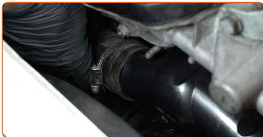
**43** Apriete las abrazaderas de las mangueras de refrigerante. Use un vaso de impacto del n.º 7. Utilice una llave de trinquete.
