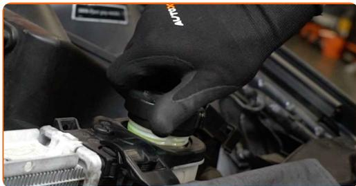
**50** Enrosque la tapa del depósito de refrigerante.
