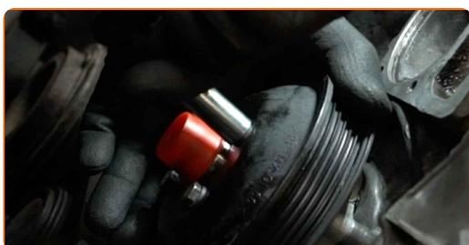
**33** Tire hacia un lado la polea tensora de la correa acanalada en V. Use un vaso de impacto del n.º 16. Utilice una llave de trinquete.
