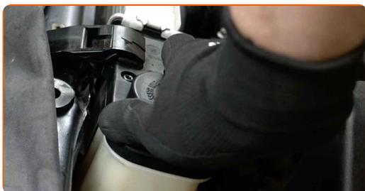
**51** Pongan en marcha el motor por unos minutos. Esto debe efectuarse para eliminar el aire residual del sistema de refrigeración y para comprobar el correcto funcionamiento de los componentes.
