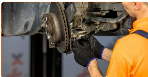
**14** Apriete la tuerca de fijación que conecta el extremo de la barra de acoplamiento a la mangueta de dirección. Use un vaso de impacto del n.º 18. Utilice una llave dinamométrica. Apriételo a un par de 65 Nm.
