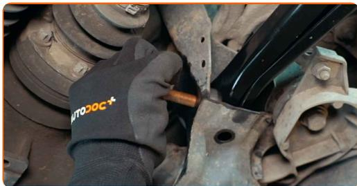
**18** Ajuste la posición del perno de alineación según la marca.
