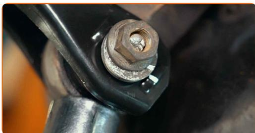
**19** Atornille las sujeciones que conectan el brazo de control a la mangueta trasera. Use una llave mixta del n.º 18. Use un vaso de impacto del n.º 18. Utilice una llave de trinquete.
