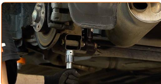
**21** Apriete la fijación inferior del amortiguador. Use un vaso de impacto del n.º 19. Utilice una llave dinamométrica. Apriételo a un par de 110 Nm.
