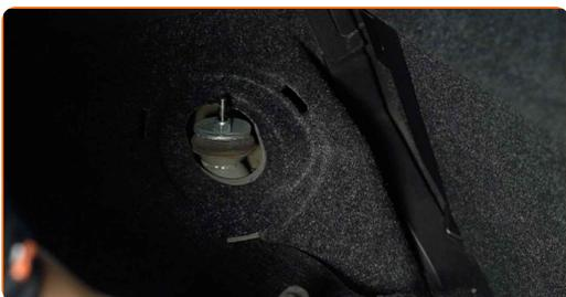
**3** Afloje la sujeción superior del amortiguador. Usa una llave mixta del n.º 17. Utilice alicates de bloqueo.
