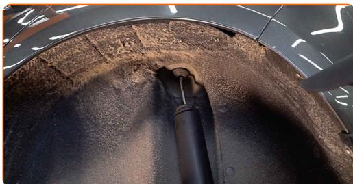
**18** Instale el perno de sujeción.
