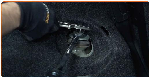
**13** Retire el perno de sujeción. Use un vaso de impacto del n.º 19.
