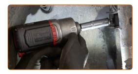
Retire el enlace estabilizador de estabilidad transversal.
