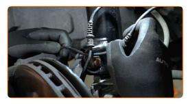
Conecte el cable del captador de desgaste de las pastillas de freno.
