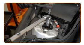
73 Trate las sujeciones del soporte del amortiguador. Use grasa de cobre.
