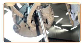
Apriete la sujeción superior que conecta el puntal de suspensión con la mangueta de dirección. Use un vaso de impacto del n.º 21. Use Vaso HEX No. H12. Utilice una llave dinamométrica. Apriételo a un par de 100 Nm.+90°
