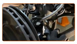
60 Conecte los cables del captador ABS.
