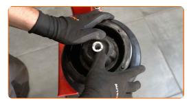
Apriete la tuerca de la varilla de la pata amortiguadora. Vaso para tuerca de amortiguador de 14X2.5 mm. Use un vaso de impacto del n.º 21. Use Vaso HEX No. H6. Utilice una llave dinamométrica. Apriételo a un par de 20 Nm.
