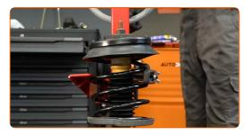
Retire el puntal amortiguador que está montado.
