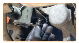
Desconecte el muñón de dirección de la pata amortiguadora. Use una palanca.
