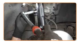
Trate todas las juntas de la bieleta o enlace estabilizador. Trate las sujeciones del amortiguador. Use grasa de cobre.
