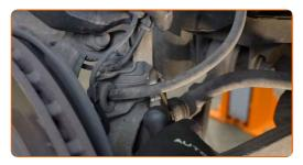
Desconecte el cableado del captador ABS.
