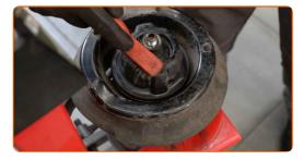
Destornille la tuerca de la varilla de la pata amortiguadora. Vaso para tuerca de amortiguador de 14X2.5 mm. Use un vaso de impacto del n.º 21. Use Vaso HEX No. H7. Utilice una llave de trinquete.
