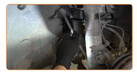
Desconecte el soporte de fijación del latiguillo de freno. Utilice tenazas.
