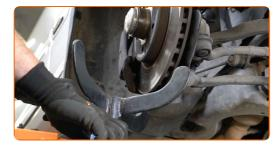
Retire el perno de sujeción.
