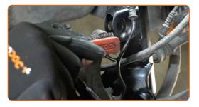
Fije la pata amortiguadora en el muñón de dirección. Use una palanca.
