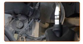
Desconecte el cable del captador de desgaste de las pastillas de freno.
