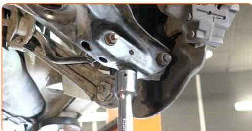
**23** Apriete la fijación de la palanca al bastidor auxiliar. Utilice las puntas XZN #12. Use un vaso de impacto del n.º 19. Utilice una llave dinamométrica. Apriételo a un par de 70 Nm.
