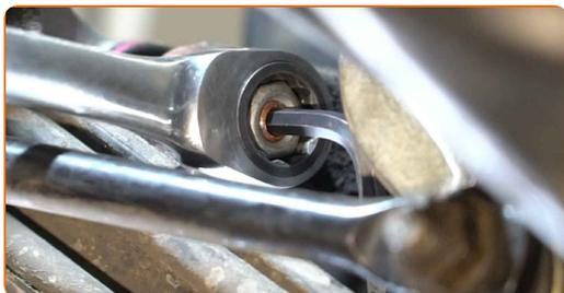
**20** Ajuste la posición del perno de alineación según la marca.
