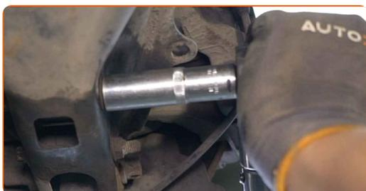
**37** Retire el apoyo de debajo de la mangueta trasera.
