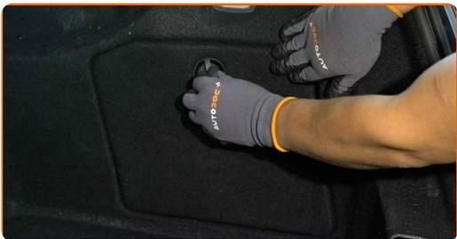
**53** Instale y apriete la argolla de amarre del maletero. Utilice Torx T40. Utilice una llave dinamométrica. Apriételo a un par de 15 Nm.
