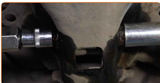
**21** Retire el perno de sujeción.
