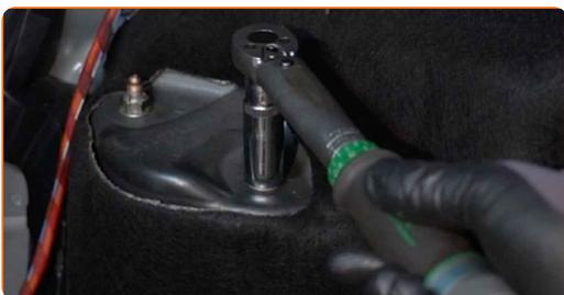
**48** Trate las sujeciones del amortiguador. Use grasa de cobre.
