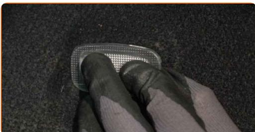
**52** Instale la cubierta del revestimiento de la parte lateral del maletero.
