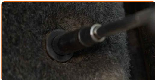
**39** Limpie las sujeciones del amortiguador inferior. Use grasa de cobre.
