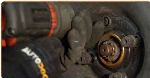
**33** Baje el automóvil y, manteniendo el orden cruzado, apriete los pernos de fijación de las ruedas. Utilice una llave dinamométrica. Apriételo a un par de 110 Nm.
