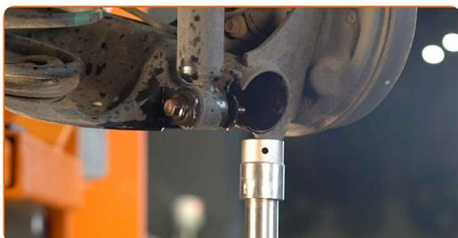
**16** Destornille la fijación inferior del amortiguador. Use un vaso de impacto del n.º 14.
