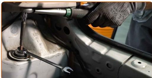
**35** Trate las sujeciones del amortiguador. Use grasa de cobre.
