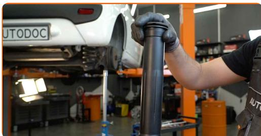
**21** Trate los asientos de montaje del amortiguador. Use un cepillo de alambre. Use el aerosol WD-40.
