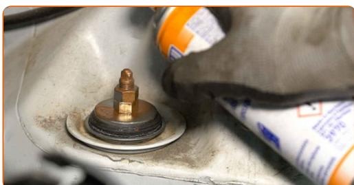
**36** Instale la cubierta de montaje sobre la sujeción superior del amortiguador.
