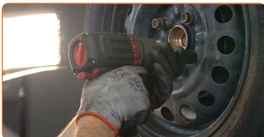
**33** Baje el automóvil y, manteniendo el orden cruzado, apriete los pernos de fijación de las ruedas. Utilice una llave de impacto para llanta # 17. Utilice una llave dinamométrica. Apriételo a un par de 100 Nm.
