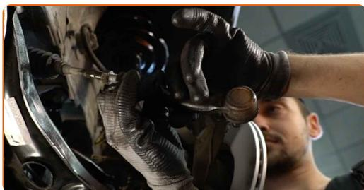
**14** Limpie los asientos de montaje del extremo de la barra de acoplamiento. Use un cepillo de alambre. Use el aerosol WD-40.
