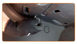
Instale el panel de guarnecido lateral. Coloque la pieza utilizando las guías y bloquee las sujeciones.
