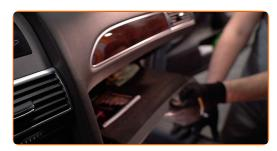
Levante, suelte cuidadosamente de las sujeciones y retire el panel de guarnecido lateral en el lado del pasajero.
