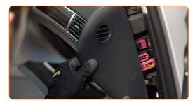
Destornille los tornillos de fijación de la guantera. Use un vaso de impacto del n.º 8. Utilice una llave de trinquete.
