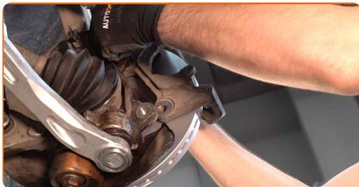
**23** Apriete la fijación de la pinza del cáliper de freno. Use un vaso de impacto del n.º 21. Utilice una llave dinamométrica. Apriételo a un par de 190 Nm.
