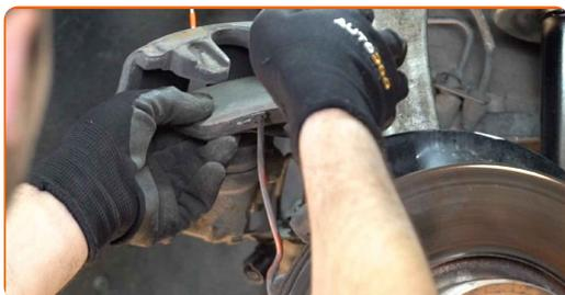
**14** Destornille la fijación de la pinza del cáliper de freno. Use un vaso de impacto del n.º 21. Utilice una llave de trinquete. Utilice una llave giramachos.
