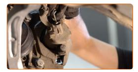
Destornille la fijación del cáliper de freno. Use Vaso HEX No. H7. Utilice una llave de trinquete.
