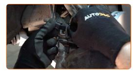
Instale el resorte de fijación del cáliper de freno. Use una palanca.
