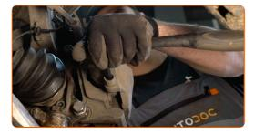
Separe el muelle de retención de la pinza de freno. Use una palanca.
