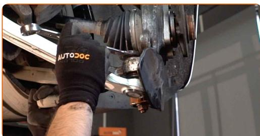
**47** Apriete la fijación del soporte esférico. Use una llave mixta del n.º 21. Utilice una llave dinamométrica. Apriételo a un par de 110 Nm.
