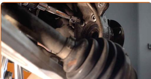
**30** Retire el cubo de rueda junto con el rodamiento. Utilice el extractor de cubos de rueda con martillo deslizante.
