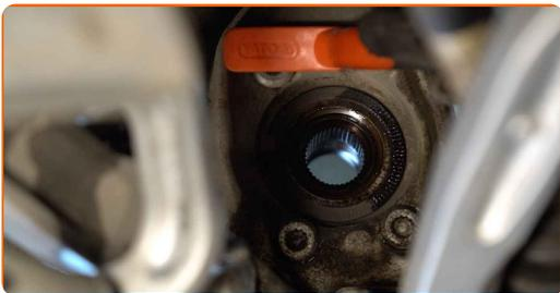
**29** Destornille la fijación del cojinete del cubo. Utilice las puntas XZN #12. Utilice una llave de trinquete. Utilice una llave giramachos.
