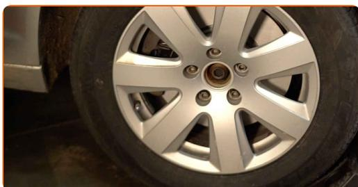
**68** Apriete el perno que conecta el eje de transmisión al cubo de la rueda. Use Vaso HEX No. H16. Utilice una llave dinamométrica. Apriételo a un par de 200 Nm.+180°
