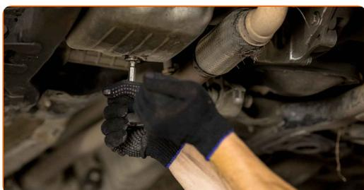
**20** Limpie el área del orificio de drenaje de la bandeja de aceite. Utilice un spray de limpieza multiuso.
