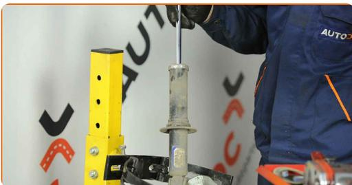
**Sustitución: amortiguador telescópico - Dodge Caliber SRT4. Consejo:**
