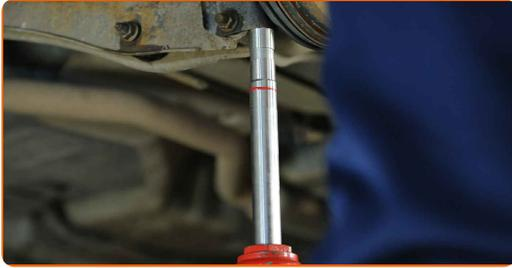
**61** Apriete las sujeciones inferiores del puntal de suspensión. Usa una llave mixta del n.º 18. Use un vaso de impacto del n.º 18. Utilice una llave dinamométrica. Apriételo a un par de 99 Nm.
