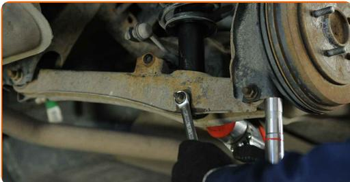
**62** Apriete la sujeción que conecta el brazo de control con el subchasis. Usa una llave mixta del n.º 18. Use un vaso de impacto del n.º 18. Utilice una llave dinamométrica. Apriételo a un par de 95 Nm.
