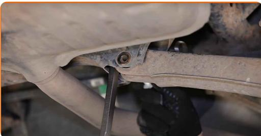
17 Separe el brazo de control. Use una palanca.
