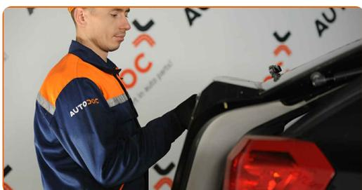
20 Retire el revestimiento inferior de la parte delantera del maletero.
