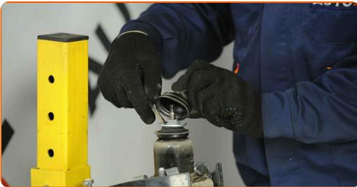
30 Trate la varilla del amortiguador. Use un cepillo de alambre. Use el aerosol WD-40.
