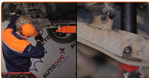
**60** Apoye el brazo de control trasero. Utilice un gato de transmisión hidráulica.
