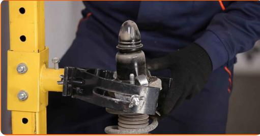
29 Retire la tapa de soporte del puntal suspensión. Utilice un destornillador plano.
