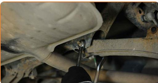
**16** Retire el perno de sujeción. Use una palanca.
