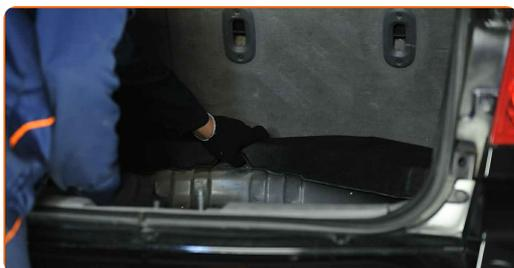
**53** Instale el revestimiento inferior de la parte delantera del maletero.
