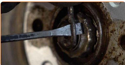
**71** Trate la superficie donde el disco del freno entra en contacto con la llanta de la rueda. Use grasa de cobre.
