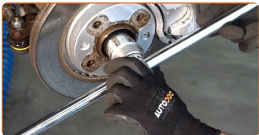
**14** Separe el eje de transmisión de la mangueta de dirección. Use un punzón. Utilice un martillo.
