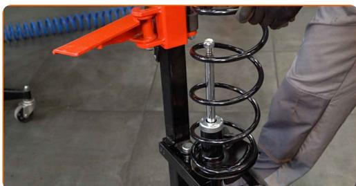
**45** Instale el guardapolvo y el tope en el amortiguador nuevo.
