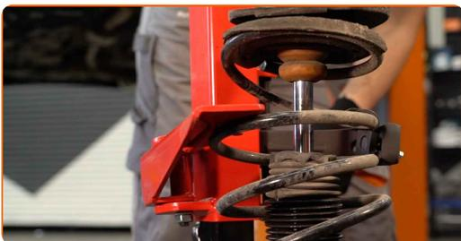
**37** Trate la varilla del amortiguador. Use un cepillo de alambre. Use el aerosol WD-40.
