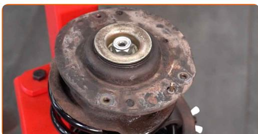
**47** Instale el soporte de montaje superior del puntal y el cojinete del soporte de montaje del puntal.
