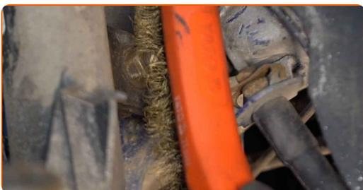
**16** Desatornille la sujeción que conecta la bieleta de barra estabilizadora al amortiguador. Use un vaso de impacto del n.º 16. Utilice Torx T30. Utilice una llave de trinquete.
