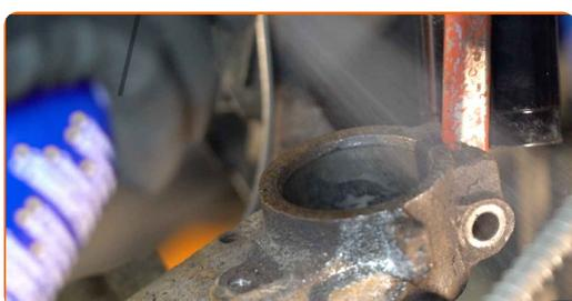
**54** Fije la pata amortiguadora en el muñón de dirección.
