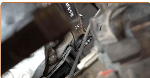
**8** Coloque la correa serpentina en la polea del cigüeñal.
