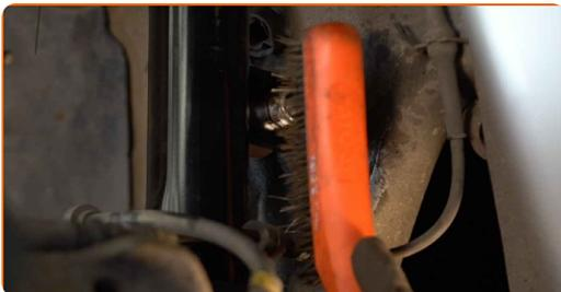
7 Desatornille la sujeción que conecta la bieleta a la barra estabilizadora. Use un vaso de impacto del n.º 17.
