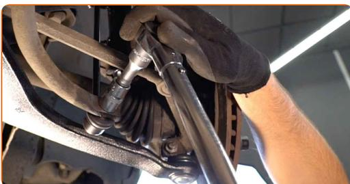
14 Trate todas las juntas de la bieleta o enlace estabilizador. Use grasa de cobre.
