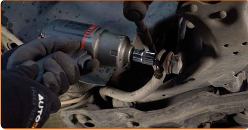
8 Desatornille la sujeción que conecta la bieleta de barra estabilizadora al amortiguador. Use un vaso de impacto del n.º 17.
