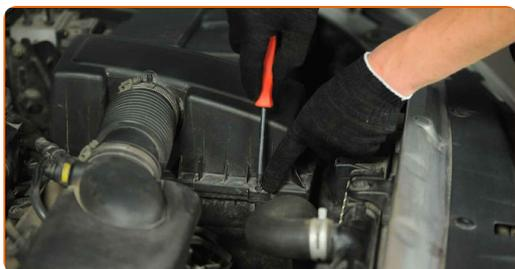
**4** Retire la cubierta del filtro de aire.
