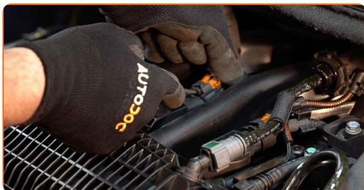
**5** Extraiga las bobinas del encendido de los pozos de la bujía.
