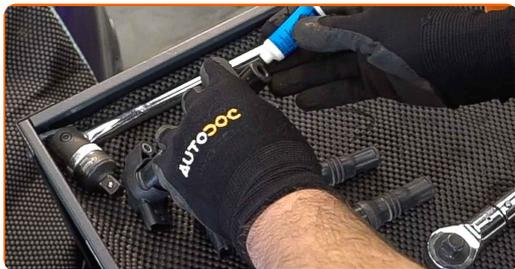
**11** Atornille las bujías nuevas y apriételas. Use el vaso de bujía # 16. Utilice una llave dinamométrica. Apriételo a un par de 22 Nm.
