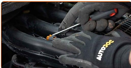
**4** Destornille la atadura de la bobina del encendido. Use un vaso de impacto del n.º 8.
