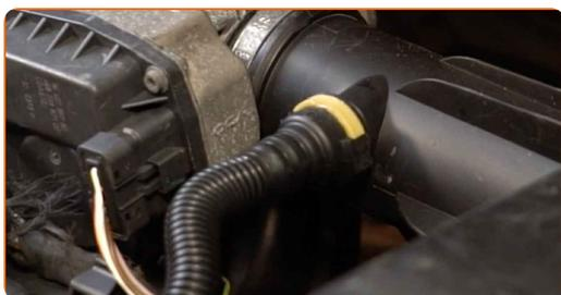
**19** Fije la abrazadera en el manguito de admisión de aire. Use un vaso de impacto del n.º 7. Utilice una llave de trinquete.
