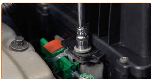
**18** Conecte la manguera de ventilación del cárter al conducto de aire.
