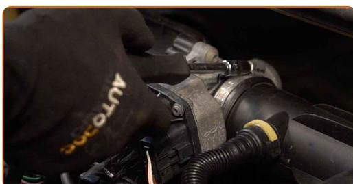
**4** Desconecte la manguera de ventilación del cárter del conducto de aire.
