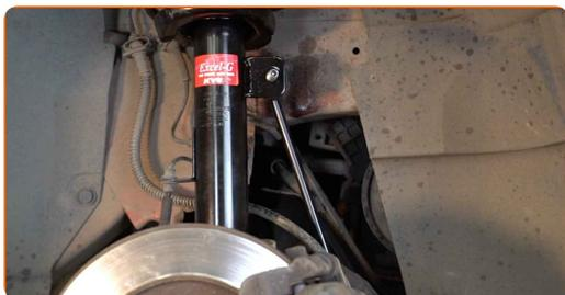
**13** Apriete la sujeción que conecta la bieleta a la barra estabilizadora. Use un vaso de impacto del n.º 17. Utilice una llave dinamo-métrica. Apriételo a un par de 35 Nm.
