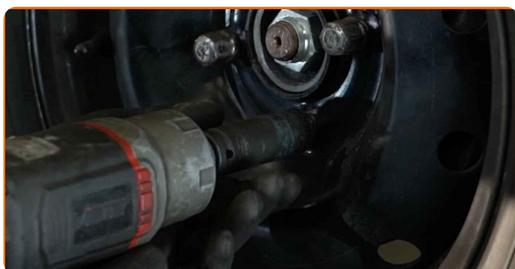
**40** Baje el automóvil y, manteniendo el orden cruzado, apriete los pernos de fijación de las ruedas. Utilice una llave de impacto para llanta # 19. Utilice una llave dinamométrica. Apriételo a un par de 90 Nm.
