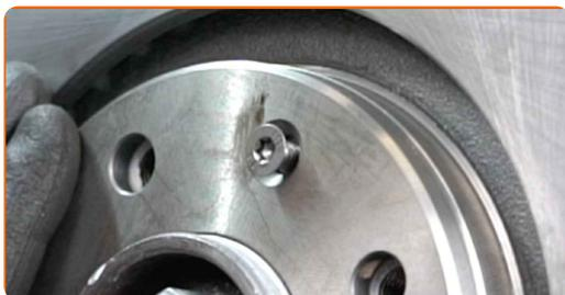
**25** Apriete las sujeciones del disco de freno. Utilice Torx T30. Utilice una llave dinamométrica. Apriételo a un par de 10 Nm.
